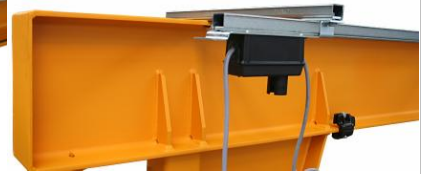
Stationaire besturing aan zwenkraan (reservebesturing)
